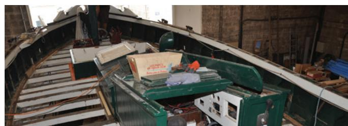
Rénovation du Christ Roi : changement du pont, remplacement d'une partie du pavois, renouvellement du circuit électrique...
